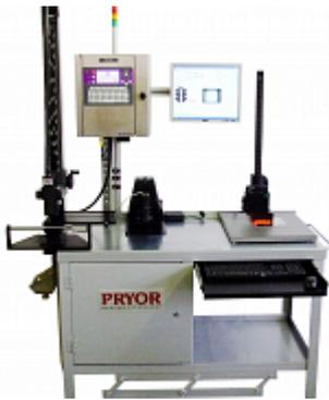
Le système de marquage jet d'encre tout-en-un de Pryor produit une marque imprimée par la propulsion de gouttelettes d'encre sur un support. Il est habituellement considéré comme un système de marquage semi-permanent et est couramment utilisé pour l'impression de textes alphanumériques, de dates de péremption, de logos et de codes-barres 1D et 2D dans les industries manufacturière, pharmaceutique, alimentaire, cosmétique, électronique et des boissons.
