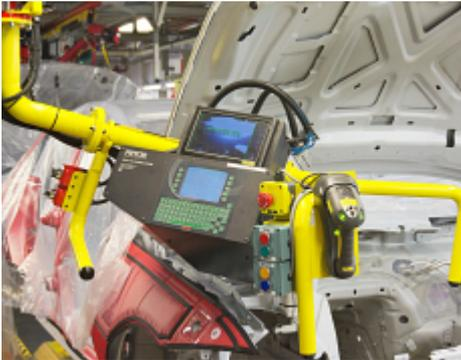
Le marquage d'un numéro d'identification de véhicule (NIV) sur un châssis automobile, un moteur ou une boîte de vitesses est une exigence essentielle. Le dispositif autonome sur mesure de Pryor pour le marquage de NIV est une solution idéale, quel que soit votre volume de production.
